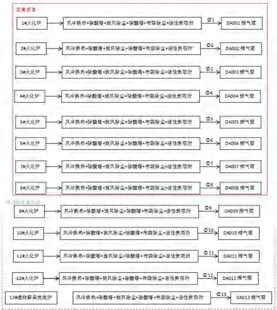
图3-2本项目废气处理工艺
