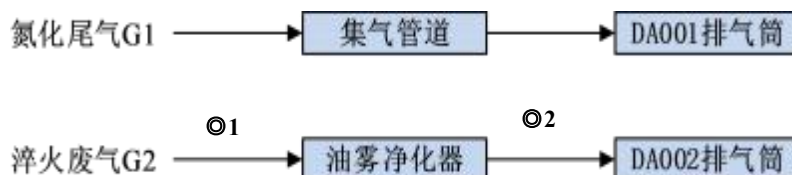
图 3-4 废气处理工艺流程图
